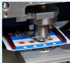
萃取单元以高压压紧 DMS 卡形成一个密闭的萃取腔，萃取溶剂沿水平方向通过样品点，然后被导入样品定量环中。可以根据应用要求，使用不同尺寸和配置的定量环。萃取物被在线的导入到其他的分析系统中，并独立于萃取溶剂的循环系统。
