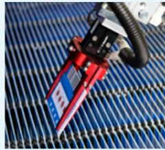
高度可靠的机械臂可以从 5 个独立的卡槽中抓取 DMS 卡，并将它们精确的移动到后续工作流程相应的模块中，在萃取后将卡片重新放置回原来的位置。每个卡槽可容纳 100 张卡片，所有 DMS 卡片均采用标准格式 84.67mm×53.2mm，不受品牌限制。
