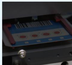
含有集成固件和适应传感器的相机模块可获取样品点的编号、位置、复选框状态和条形码信息。在整个过程中都确保 DMS 卡与其条形码之间的匹配。CAMAG 依靠其超过十余年的 HPTLC 光学图像分析技术构建了这一精确可靠的相机模块。
