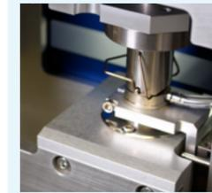
特制的清洗工作站会清洗所有与 DMS 卡接触的部件并冲洗整个管路，以避免任何残留。不同用户分别进行了独立测试，确证该系统无样品残留问题。
